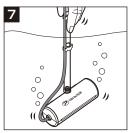
USBコードを軽く上下に振って モバイルバッテリーやUSBコンセン 水中ポンプのケース内の空気を トの電源へUSB端子をつなぎます。 出します。
